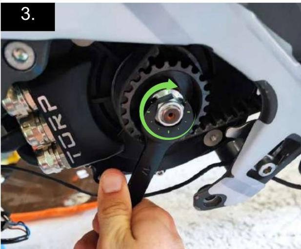
Lorsque tout est monté, appuyez sur le frein arrière et serrez l'écrou (sens des aiguilles d'une montre) un peu plus à 40-50 Nm.
